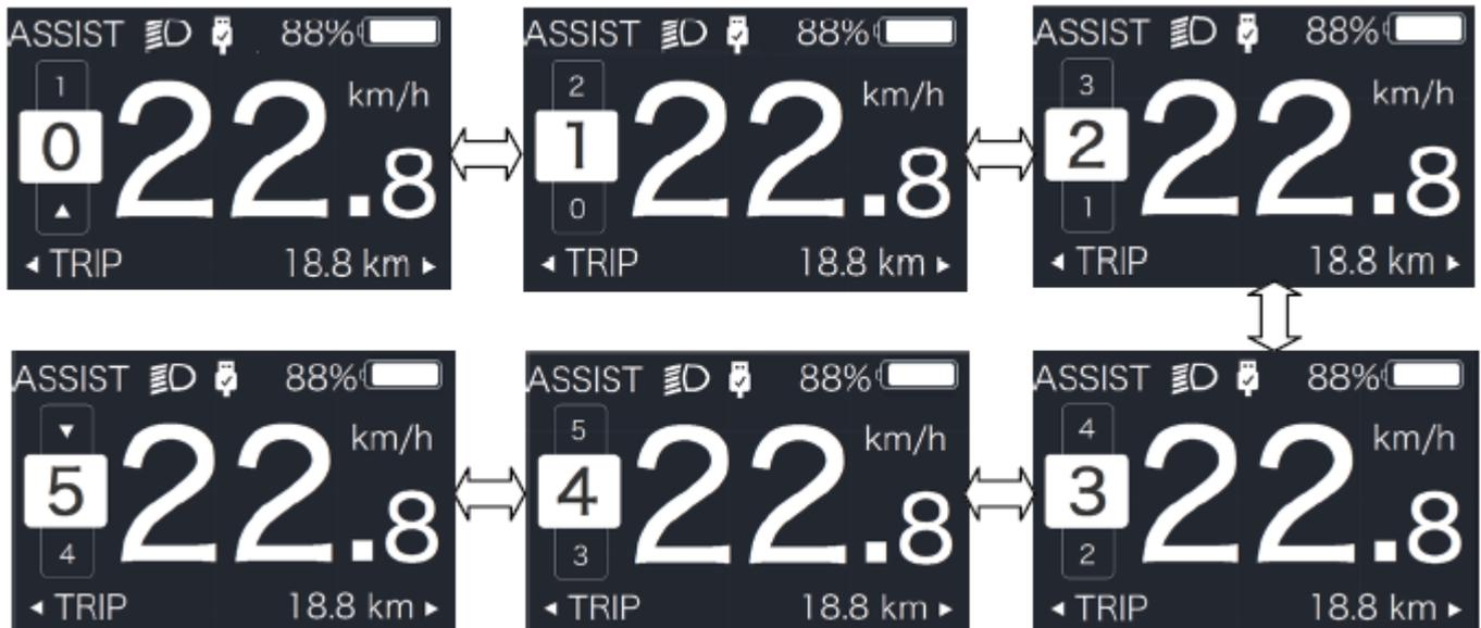
Si le contrôleur a la fonction Boost, ce mode peut être sélectionné en appuyant brièvement sur la touche +.
